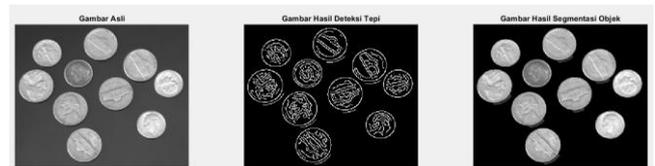
Gambar 3.6 Screenshot pengujian *image clipper* untuk gambar koin dengan pendeteksian tepi (Sumber: Dokumentasi Penulis)
