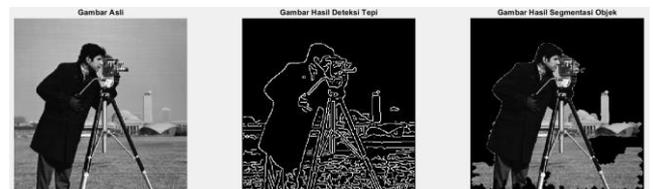
Gambar 3.7 Screenshot pengujian *image clipper* untuk gambar cameramen dengan pendeteksian tepi (Sumber: Dokumentasi Penulis)
